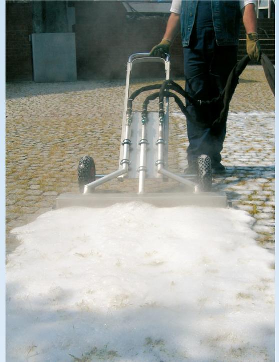
Ohne Druck wird das heiße Wasser auf die zu behandelnde Fläche aufgebracht. Der direkt danach ausgebrachte Schaum dient hierbei als Wärmeisolator und hält die Wärme lange an den Pflanzen. Durch die Hitze **gerinnt das Zelleiweiß** und die Pflanzen werden zerstört. Es lassen sich ein- und mehrjährige Pflanzen, aber auch Samen bekämpfen. Die abgestorbenen Pflanzenreste können in einem zweiten Arbeitsschritt entfernt werden.
